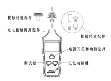
注意:为了安全起见,测量高转速时建议用光电式测量。
